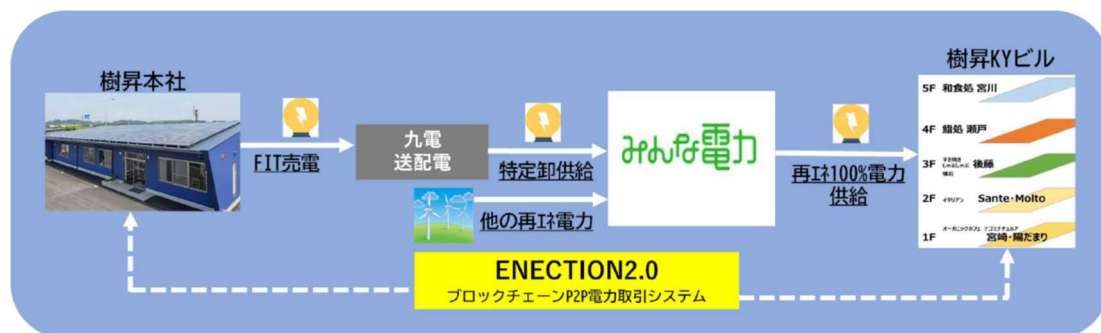
自社ビル内で利用する電力の再生可能エネルギー100%化のスキーム
